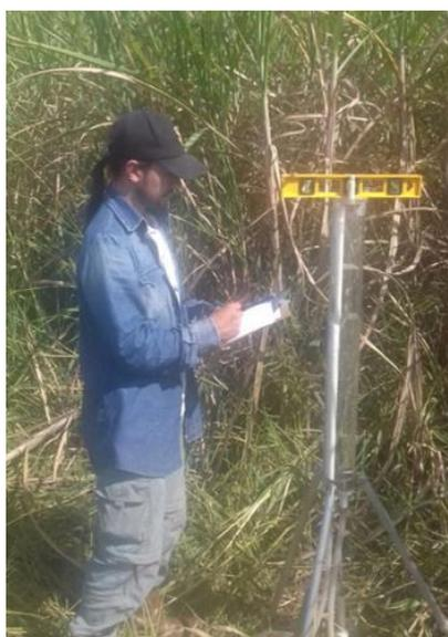
**Figura 12:** operação do permeâmetro de Guelph adaptado
