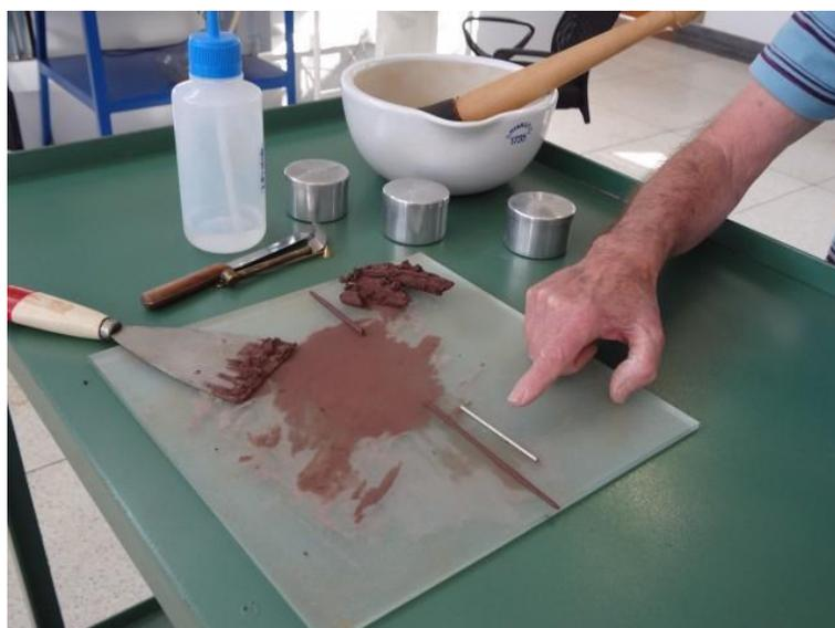
**Figura 9:** Ensaio para determinação do índice LP (Fonte: <http://www.labgeo.ufscar.br/images/pages/03562.jpg>)
